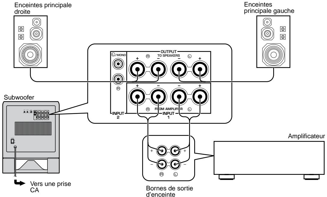
**Si l'amplificateur est équipé de deux paires de bornes de sortie d'enceintes**
